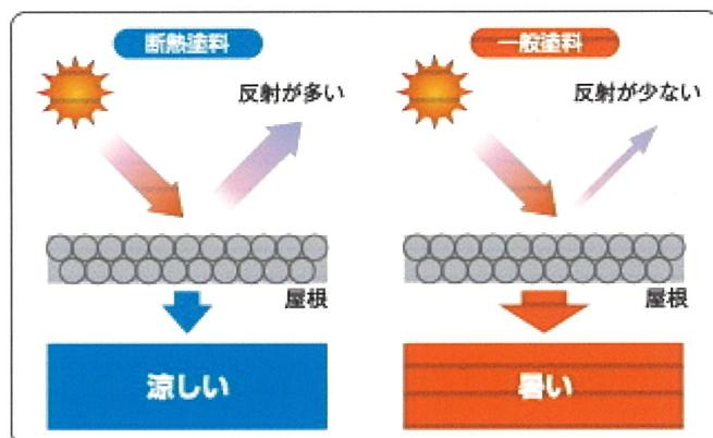
日射熱を遮断する断熱塗料のイメージ図です。通常の白色塗料でもかなりの反射率があり太陽光を遮断する効果はありますが、外気温などを遮断するには断熱塗料が有効です。
